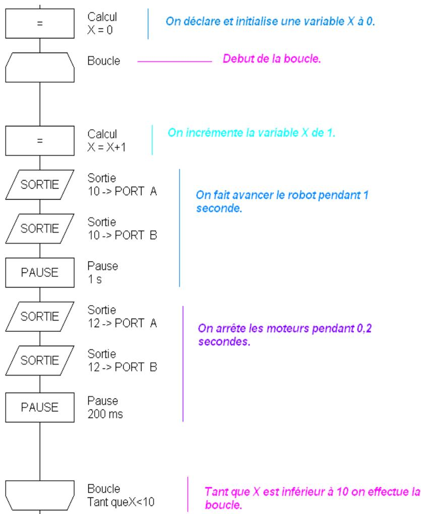
Voilà maintenant on va faire une accélération. Là il va falloir agir sur l'intervalle de temps d'arrêt des moteurs et le rendre de plus en plus petit.
