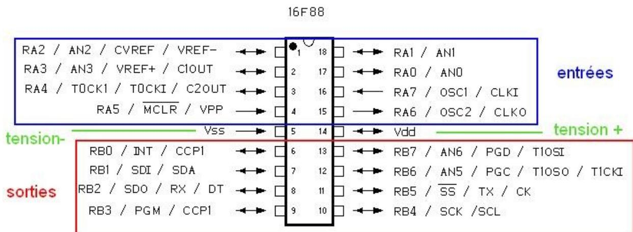
Ce PIC délivre 25mA à chaque sortie. Pour nos transistors on a désormais  $I_B = 25\text{mA}$ . De plus le PIC fonctionne à 5V ce qui convient pour notre alimentation de 4,5V.
