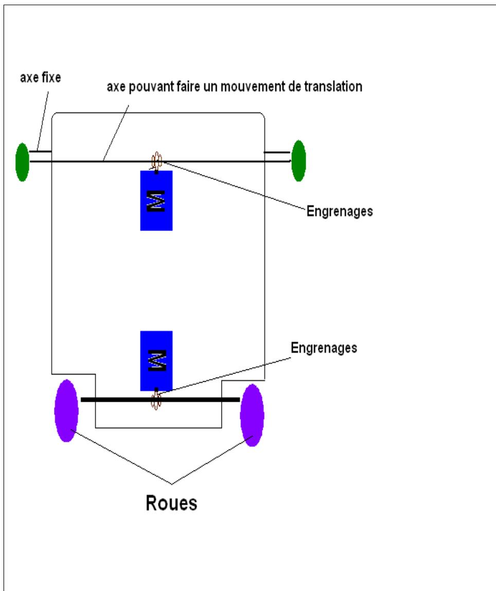
Soit nous utilisons les deux moteurs pour la propulsion, un pour chaque roue, et une roue folle qui permet de rester en équilibre.
