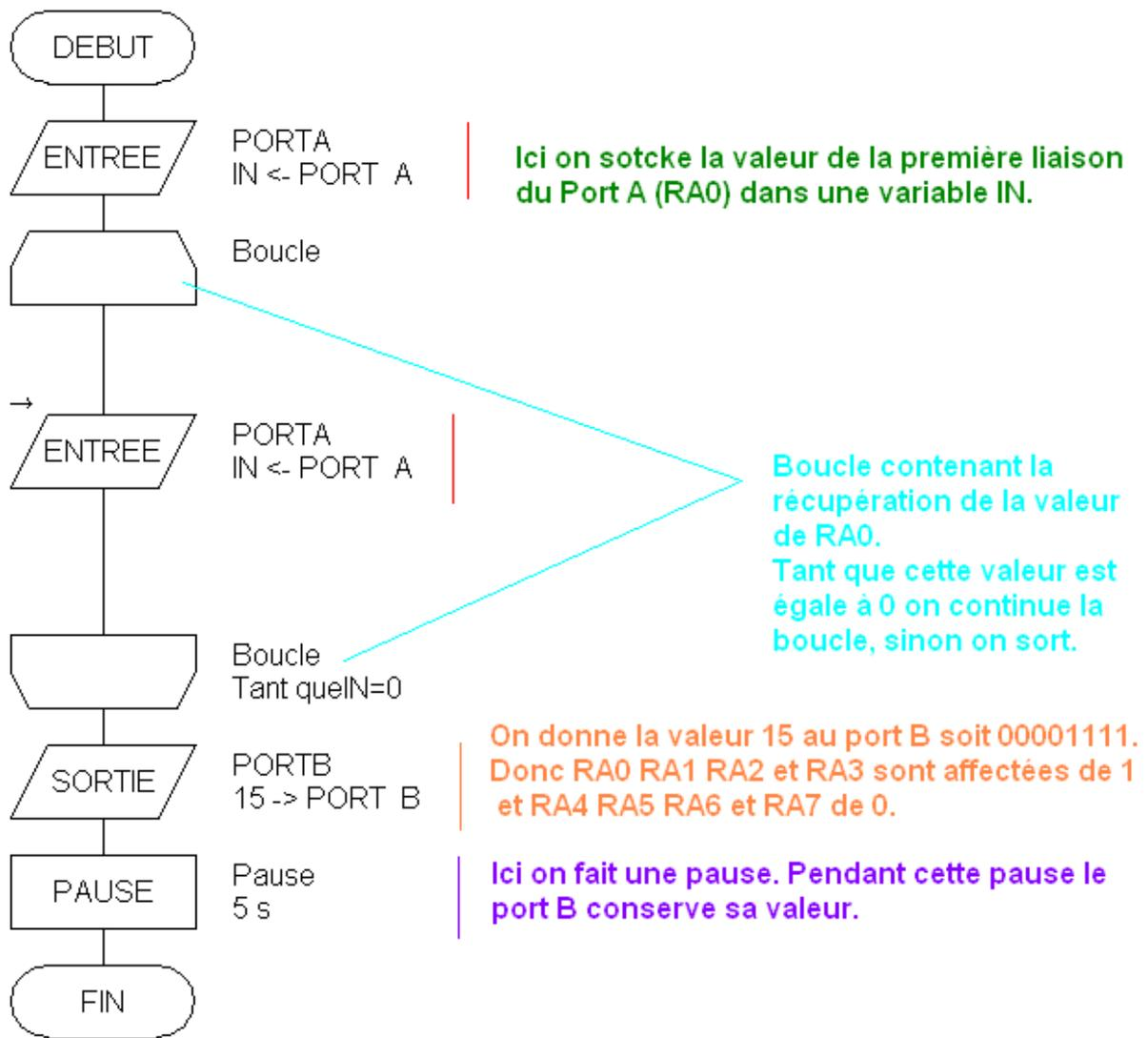
Et voici la simulation du programme après avoir connecté ( virtuellement ) quatre LEDs à RB0, RB1, RB2 et RB3 et un interrupteur à l'entrée RA0 :
