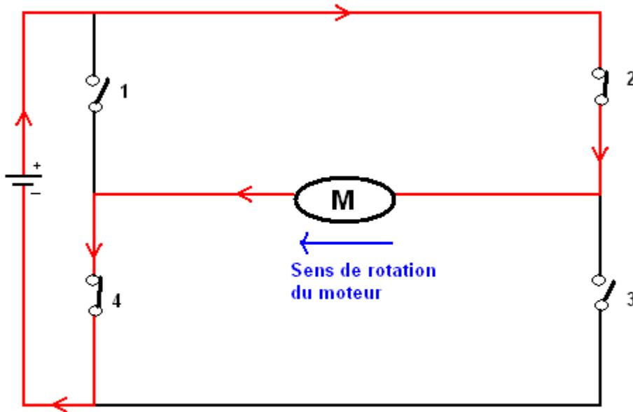
Ici le moteur tourne dans le sens inverse des aiguilles d'une montre, le robot recule.
