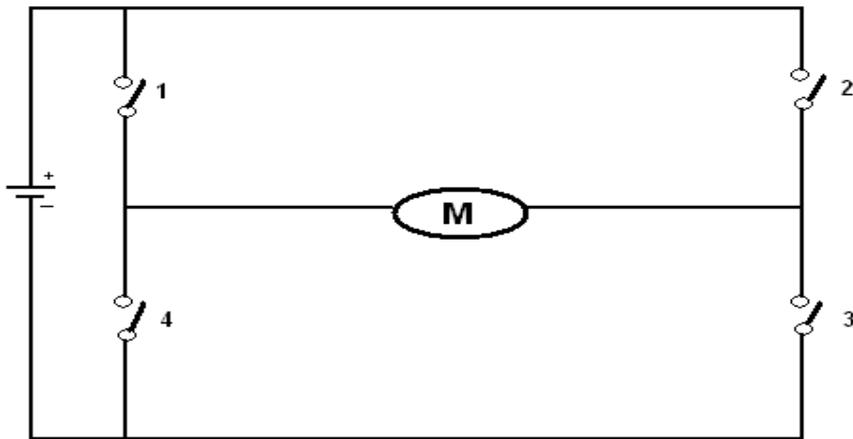
Ici on voit quatre interrupteurs qui vont fonctionner en couple. Effectivement si on ferme le 1 et le 3, on obtient le schéma suivant :
