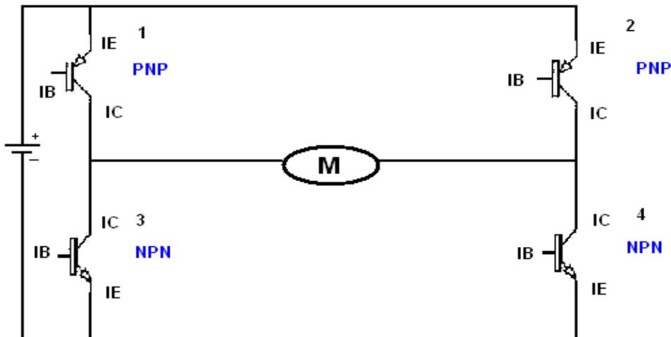
Ici on voit la disposition des transistors suivant leur type (NPN ou PNP). En effet celle-ci dépend de la borne ou patte de l'émetteur (sur le schéma : IE). Elle doit être directement reliée à l'alimentation.
