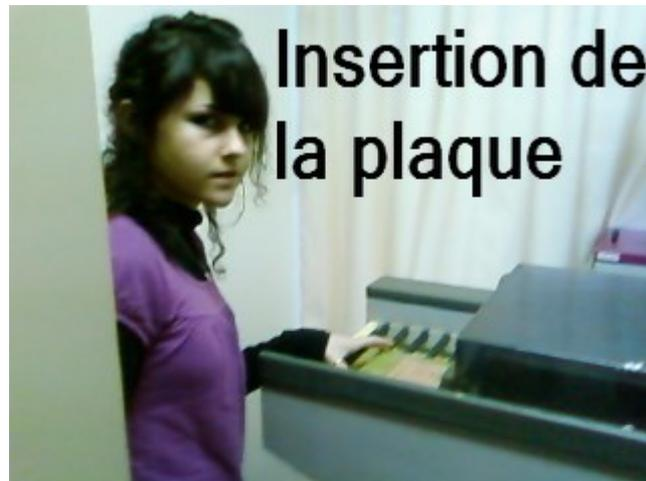
Celle-ci va soumettre la plaque à du perchlore de fer qui va attaquer le cuivre non protégé par la résine.
