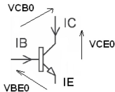
$V_{CBO}$  est la tension qui traverse la base et le collecteur,  $V_{CE0}$  celle qui traverse l'émetteur et le collecteur et  $V_{BE0}$  la tension entre l'émetteur et la base.
