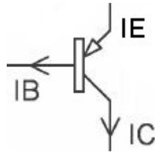
Dans le cas des NPN, si on envoi du courant en IB (Intensité à la Base) le courant va circuler entre IE (Intensité à l'Emetteur) et IC (Intensité au Connecteur). On dit alors que le transistor est **saturé**. En revanche si le courant en IB est nul, le courant ne circulera pas entre IE et IC, on dit alors que la transistor est **bloqué**.
