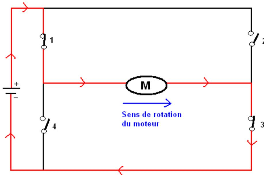
Dans ce cas le moteur tourne dans le sens des aiguilles d'une montre, le robot avance.
