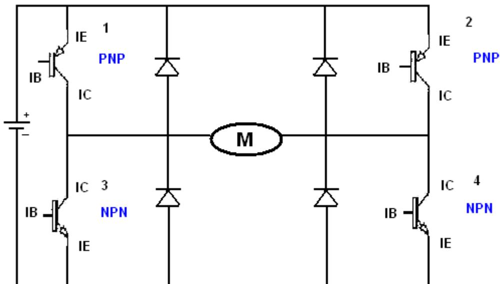
En plus de cela, les transistors permettent de moduler les signaux électriques. Par exemple si on sature les transistors 1 et 4 pendant  $i_1 = 500\text{ms}$  puis qu'on les bloque pendant  $i_2 = 500\text{ms}$  et ainsi ensuite on obtient un signal presque sinusoïdal. En modifiant les intervalles de temps  $i_1$  et  $i_2$  on agit sur la vitesse de déplacement du robot.
